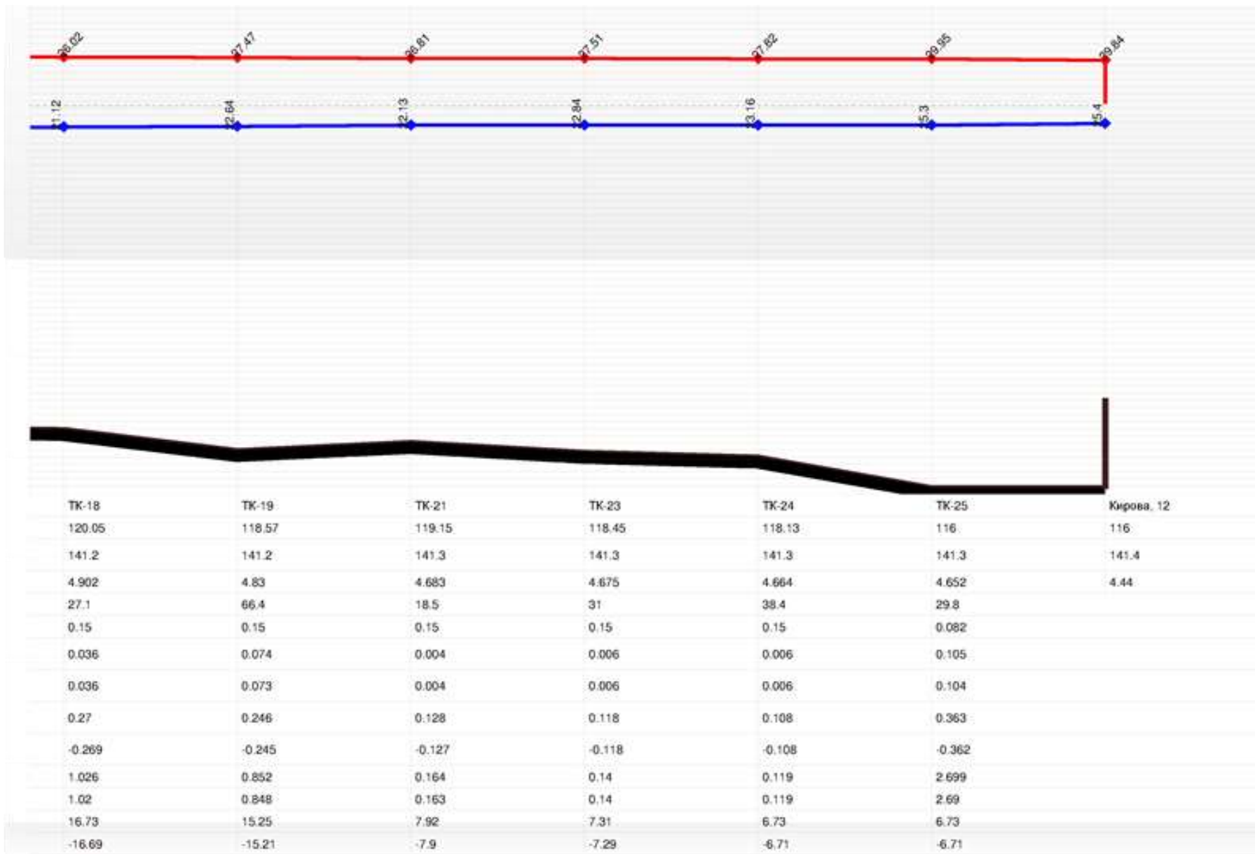
Рисунок 80 Гидравлический режим тепловых сетей и пьезометрический график от котельной «Центральная» до потребителя по ул. Кирова, д.12 (конец).
