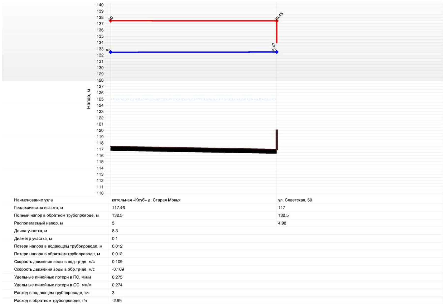
Рисунок 107 Гидравлический режим тепловых сетей и пьезометрический график от котельной «Клуб» до здания клуба по адресу: д. Старая Монья, ул. Советская д.50
