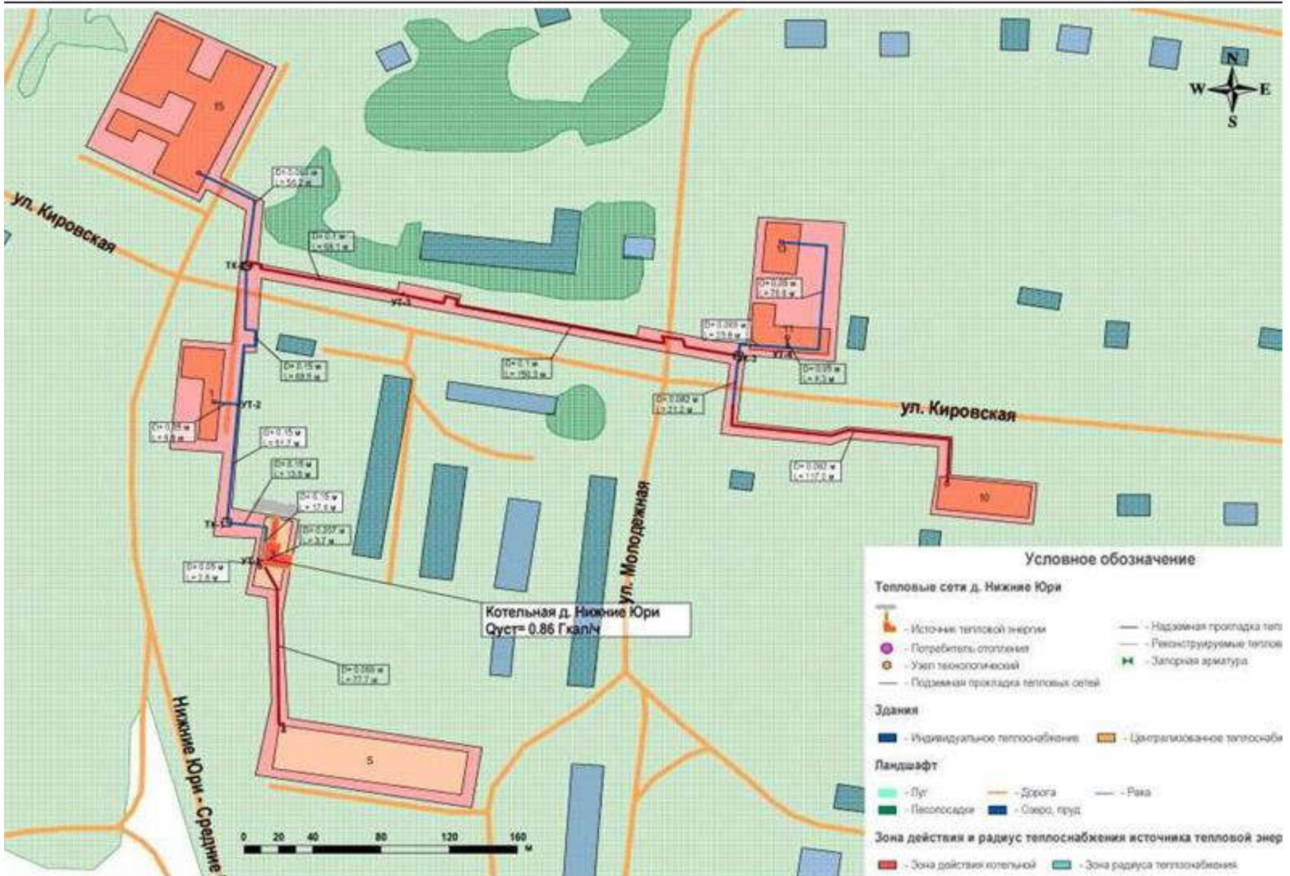
Рисунок 84. Перспективная зона действия системы теплоснабжения и источника тепловой энергии – котельная д. Нижние Юри.
